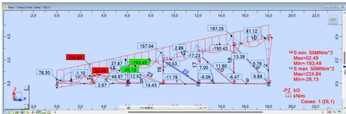
Рис. 17. Перевірка міцності запроектованої ферми.
