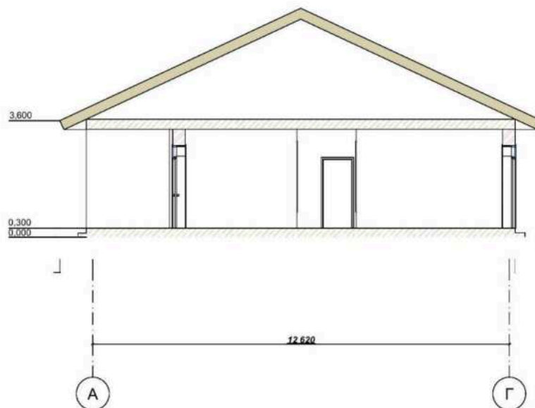
Рис. 12. Розріз адміністративної будівлі в осях А-Г.
