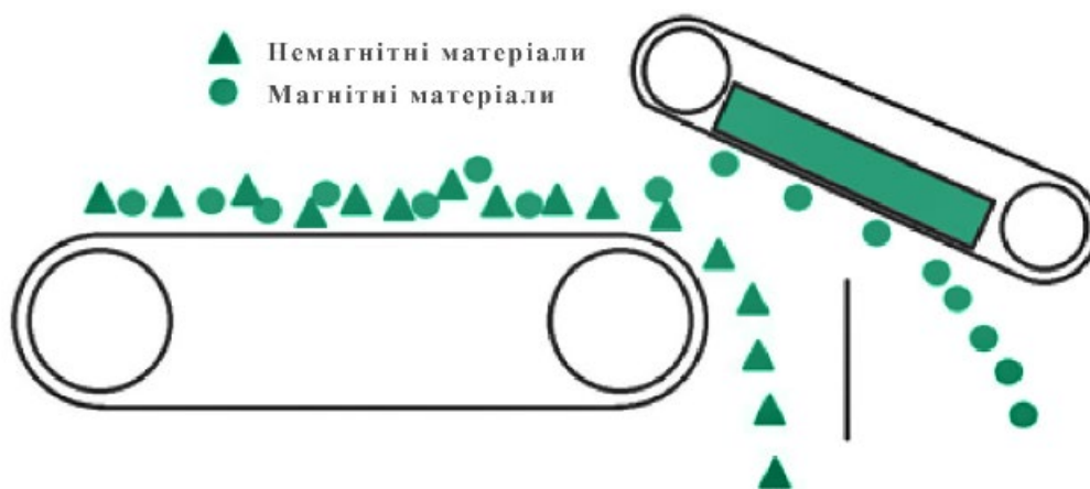
Рис. 2.1.2.1 Принцип роботи магнітного сепаратора
