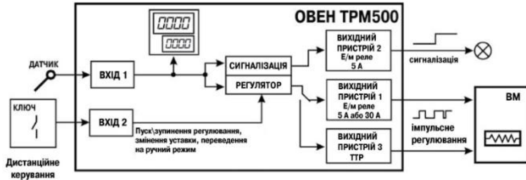
Рисунок 2.10 – Схема підключення терморегулятора з дистанційним керуванням
