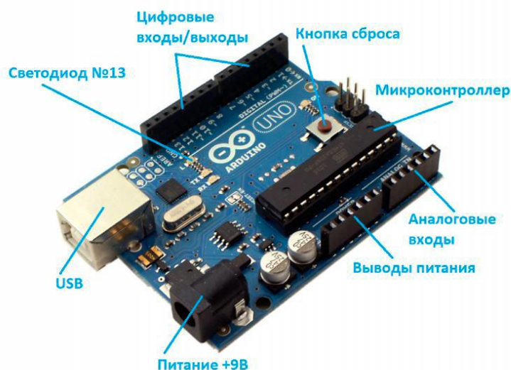
Рисунок 2.3 - Основные элементы Arduino Uno
