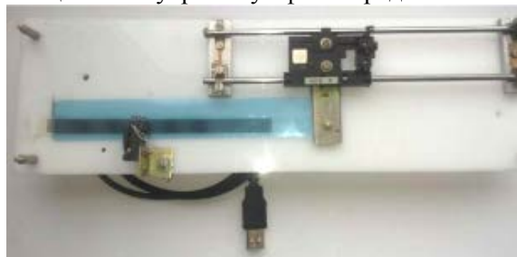
Рисунок 1 – Загальний вигляд датчика лінійних переміщень на муаровому ефекті
