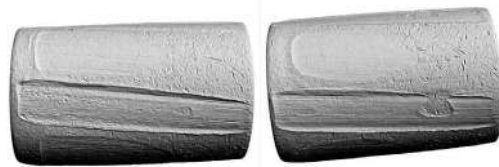
Рис. 1. Зображення 3D-моделей стріляних куль зі слідами нарізів каналів ствола, виготовлені засобами програмно-апаратного комплексу BalScan
