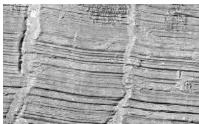
Рис. 3. Зображення слідів на циліндрі замка
