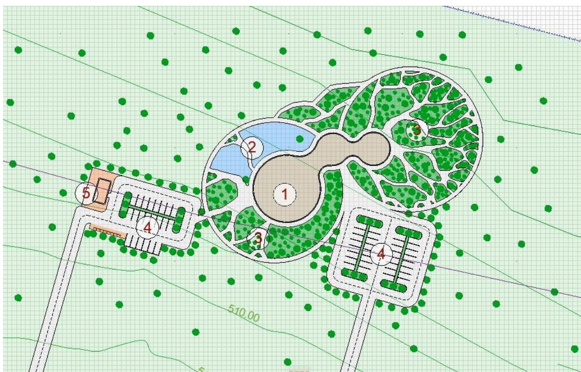
Рисунок 2.3 — Схема функціонального зонування території реабілітаційного центру. (№1-лікувально-реабілітаційна зона; №2-зона активної фізичної реабілітації; №3- рекреаційно-терапевтична зона; №4-транспортна зона; №5-господарсько-сервісна зона)
