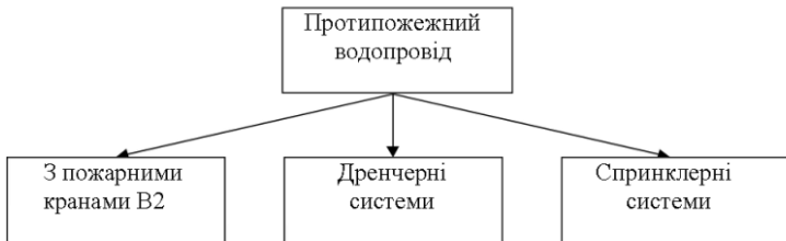
Рисунок 2 - Класифікація протипожежних водопроводів
