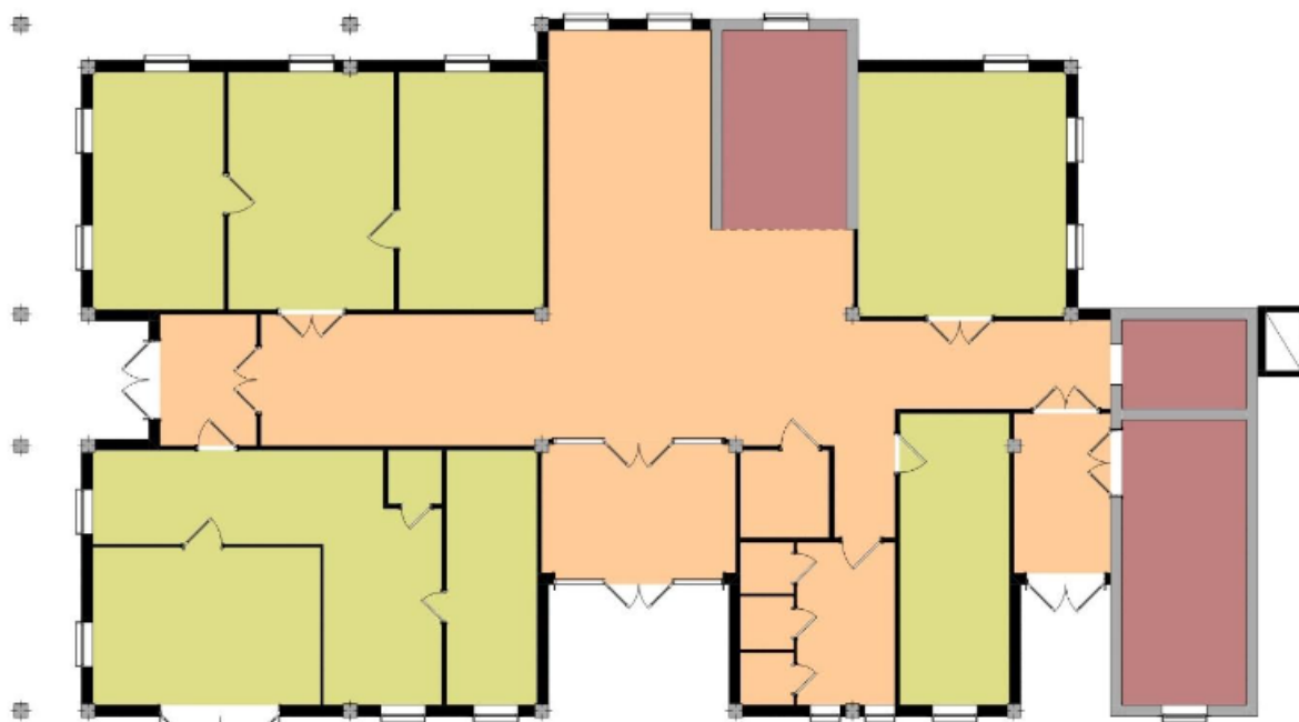
Мал.4.3. Схема функціонального зонування 1 поверху проектованої будівлі
